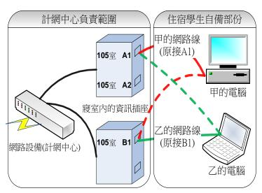
為了釐清問題,最簡單的方法,即交叉測試. 假設甲同學的電腦(接在資訊插座 A1)在寢室內可以上網,但乙同學的電腦(接在資訊插座 B1)不行上網,表示甲同學的電腦硬體設定皆正常,資訊插座 A1 也是正常的,而乙同學的電腦或資訊插座 B1,至少其中一個有問題。此時。請將乙同學的電腦接到 A1。而甲同學的電腦接到 B1。特別注意甲電腦需申請**臨時使用**,若乙同學電腦接到 A1,仍不能上網,表示乙同學的電腦硬體或設定有問題(使用舊機制的宿舍,也可能是登錄在宿網管理系統上的 MAC 有問題);反之,若乙同學電腦接到 A1 即可上網,表示資訊插座 B1 可能故障,此時,甲同學的電腦接到 B1,應該也是無法上網的。這種情形,是資訊插座 B1 故障了,須請乙同學登入到宿網管理系統去進行申告。宿網維修工程師,將會安排時間前往維修(約3天內)。
